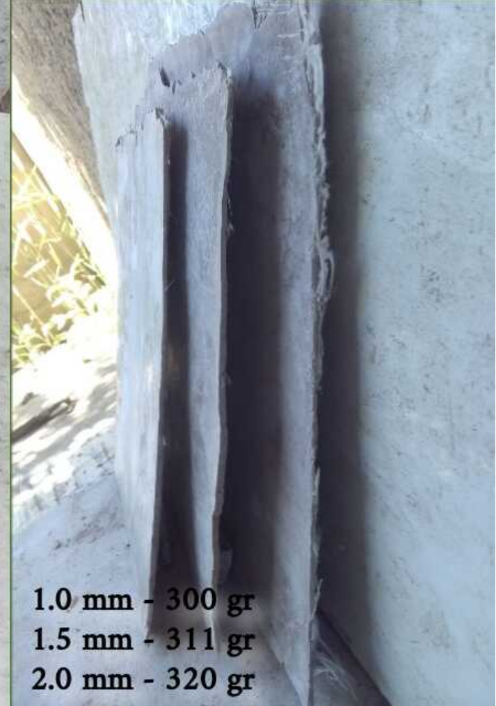
300 gr/M2 Cam Elyaf uygulaması, 1 kat- 2 kat - 3 kat. 20x 300 cm
