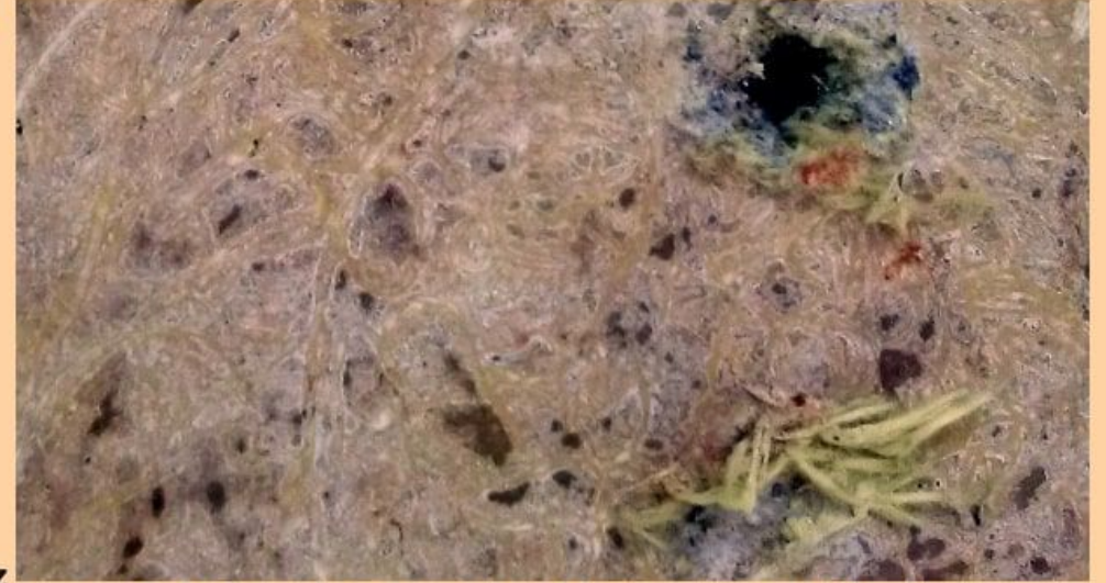
2 cm kalınlığında Tvaron destekli G3 mermisini durduran test plakamız
